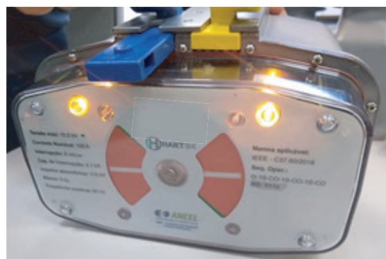
Figure 3 - Religador Rocket-1 saindo do MODO ECO
