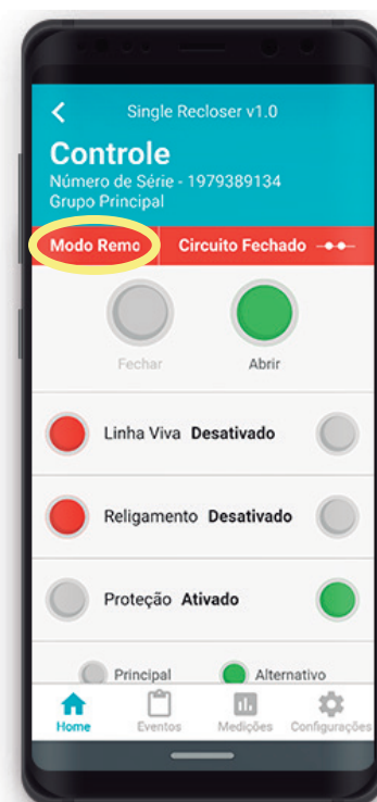
Figure 3 - Religador Rocket-1 saindo do MODO ECO
